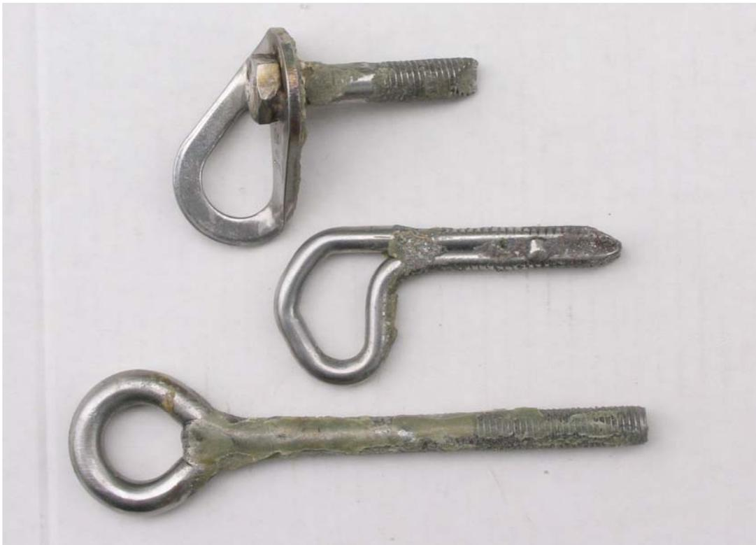
*An diesen Haken wurde geklettert. Der Mörtel hatte nicht abgebunden. Alle Haken wurden per Hand ausgezogen. Eine Abschlusskontrolle hätte diese Gefahrenquellen früher aufgedeckt.*
