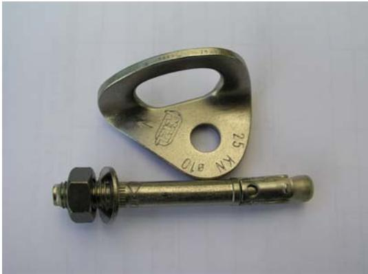
Der Expressanker (auch als Schwerlastanker, Segmentanker oder Durchsteckanker bezeichnet) ist das zurzeit am weitesten verbreitete Bohrhakensystem. Kosten und einfache Montage sprechen für dieses System. Eine gewisse Gefahr besteht beim „Überdrehen“ der Mutter. Laut Setzanweisung muss das zulässige Drehmoment eingehalten werden. Für den Bergsport sind Dübel mit dem Durchmesser M10 (Länge ca. 75 mm) und M12 (Länge ca. 85 mm) sinnvoll.
