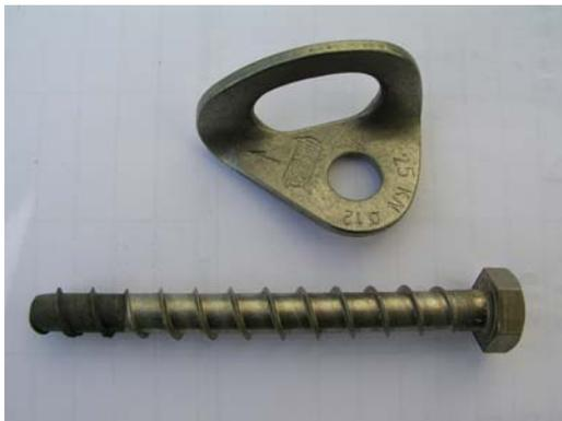
Der Multi-Monti Schraubanker (auch als Betonschraube bezeichnet) funktioniert verblüffend einfach. Entsprechend dem Schraubenschaft wird ein relativ dünnes Loch gebohrt. Anschließend wird die Schraube in das Loch geschraubt. Dabei schneidet die Spitze der Schraube ein Gewinde in den Fels, ähnlich einer Eisschraube im Eis. Dieses System ist Spreizdruckfrei, bietet einen vorbildlichen Formschluss. Der Haken ist sofort belastbar.
