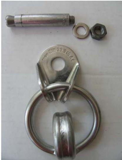
Der Vorteile der Zykon-Hinterschnittanker liegt darin, dass sie nahezu Spreizdruckfrei sind. Dadurch entsteht keine Sprengwirkung auf den umliegenden Fels. Der Haken ist sofort belastbar. Nachteile sind der sehr hohe Anschaffungspreis, ein großer Bohrlochdurchmesser und das notwendige Spezialwerkzeug in Form von Hinterschnittbohrer und Eintreibmeißel. Zur Montage ist ein Drehmoment einzuhalten. Die Abmessungen des Systems entsprechen nicht der neuen Norm (Durchmesser 14 mm, Länge 60 mm).
