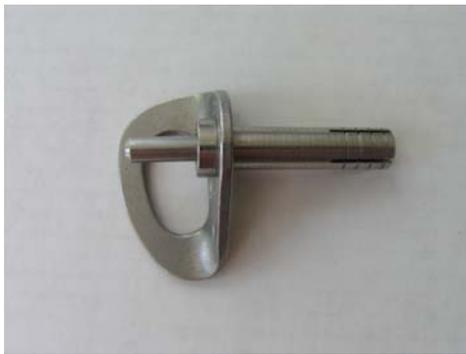
Der Einschlaganker (auch als Nagelanker oder „Long-Life Haken“ bezeichnet) funktioniert sehr einfach in der Anwendung. Außer dem Bohrer und einem Hammer wird kein zusätzliches Werkzeug benötigt. Deutliche Nachteile bilden die geringe Setztiefe in Verbindung mit einem sehr hohen Spreizdruck nahe der Felsoberfläche und der relativ hohe Preis. Nach neuer Bohrhakennorm in der üblichen Abmessung (Länge 45 mm, Durchmesser 12mm) nicht mehr normkonform.
